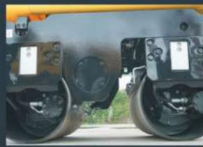
Два гидромотора хода американского производства
