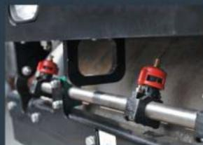
Система орошения воды под давлением с насосом высокого качества с разнесенной системой распыления. Легкий доступ к форсункам, защищенным от ветра
